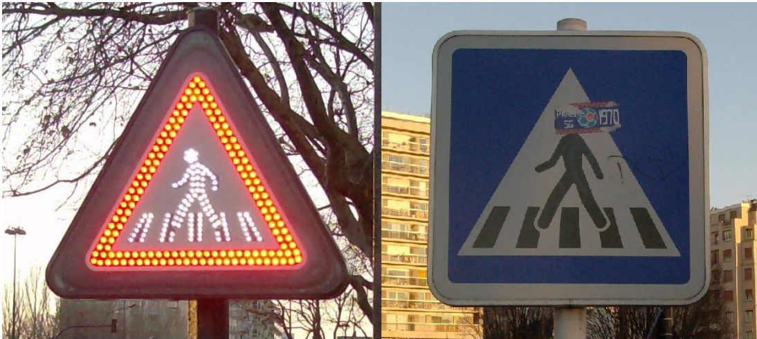
Figuras 18 y 19. Cruce de Avenue Porte de St Cloud . El sentido saliente cuenta con dos señales parpadeantes, el sentido entrante sólo una pintada.
