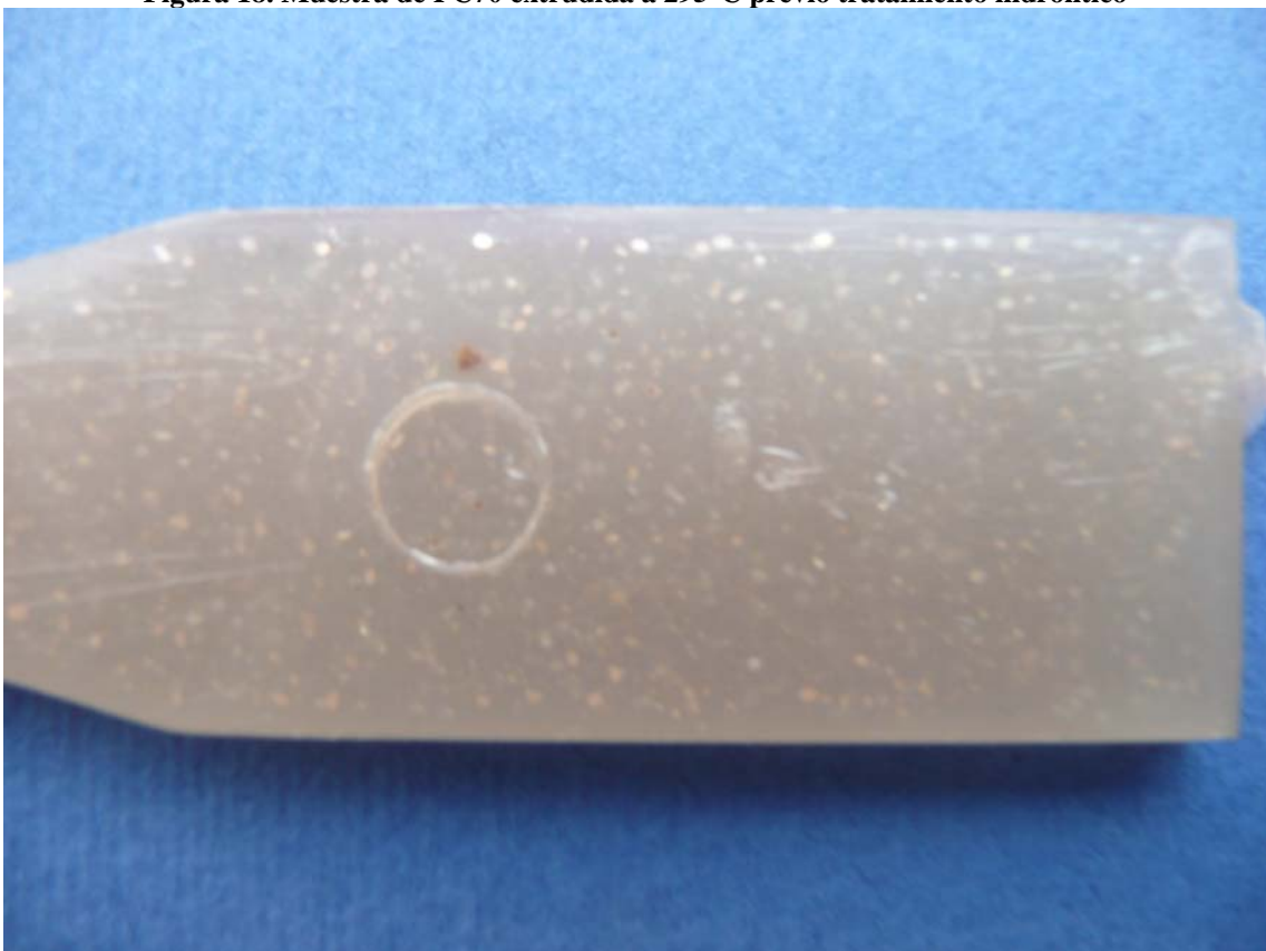
Figura 19. Muestra de PC70 extrudida a 295°C después del tratamiento hidrolítico
