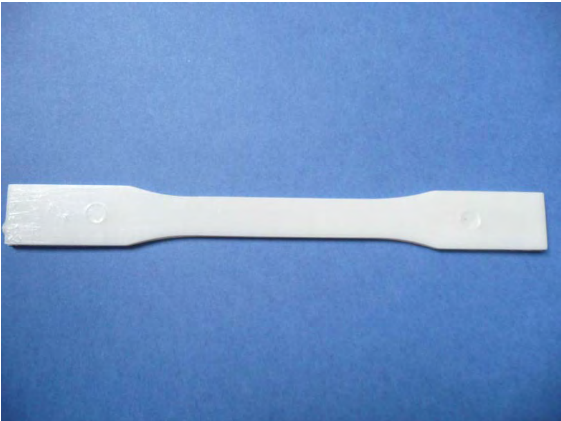
Figura 16. Mezcla PC100 extrudida a 275°C
