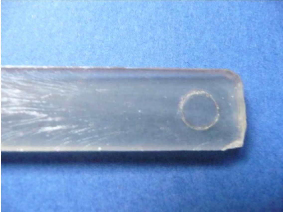
Figura 18. Muestra de PC70 extrudida a 295°C previo tratamiento hidrolítico
