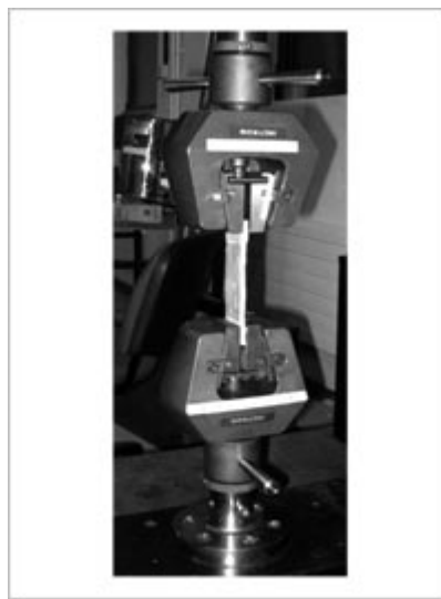
Figura 10. Ensayo de resistencia a la tracción
