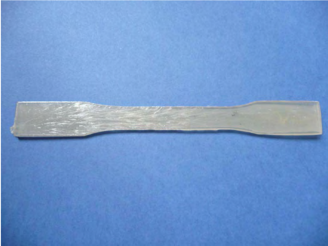
Figura 17. Mezcla PC80 extrudida a 295°C
