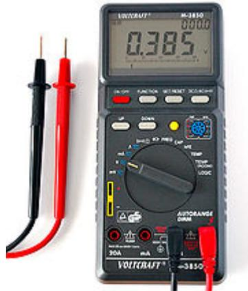
FIGURA 26: Multímetro digital donde pueden medirse varias magnitudes eléctricas.
