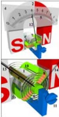
FIGURA 22: Principio de funcionamiento de un galvanómetro.
