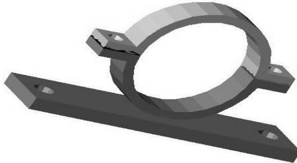
FIGURA 2.25 ABRAZADERA PARA MASTIL.
