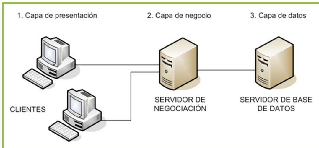
Figura 5.1. Diagrama de programación por capas.
