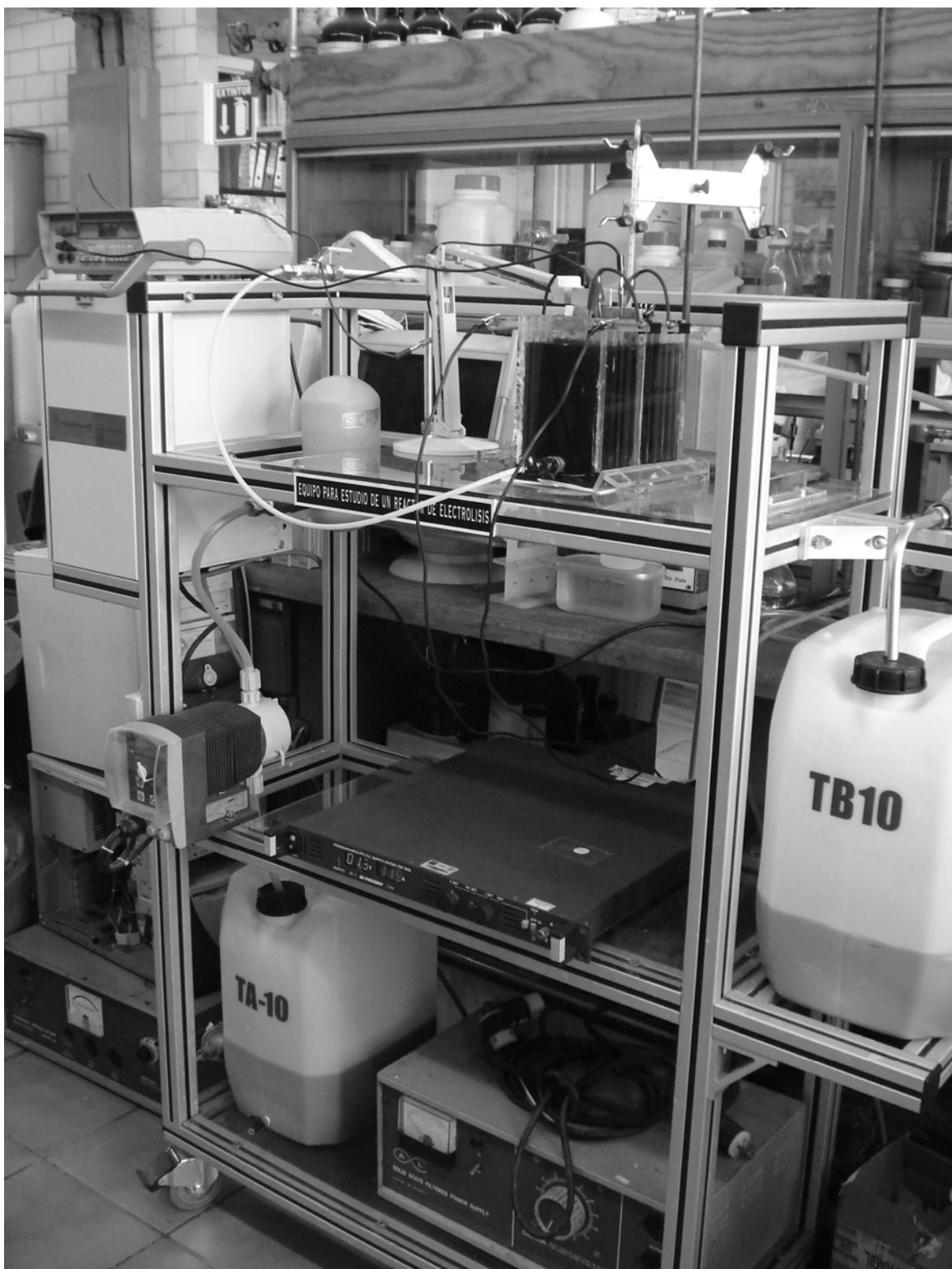
Figura 3. Equipo de electro-refinación de cobre.
