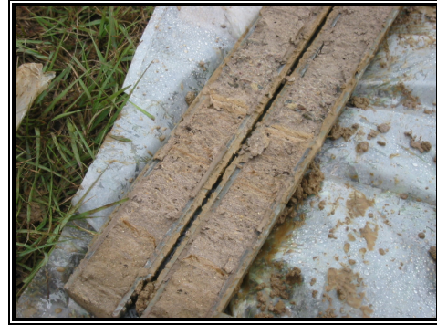
Figura 2.8. Obtención de muestras alteradas.
