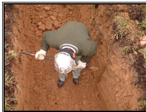
Figura 2.2. Recolección de muestra inalterada.
