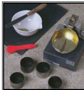
Figura 2.15b. Muestra de suelo dentro de la copa de Casagrande.
