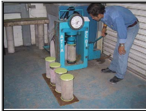
Figura 4.26. Ensaye a compresión simple.
