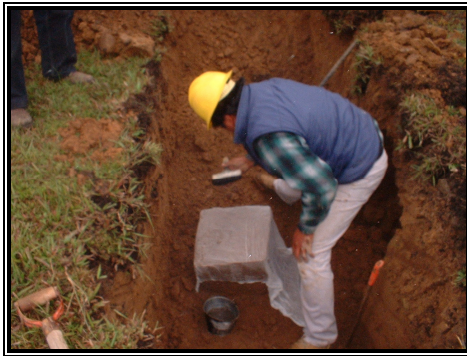
Figura 2.3. Obtención de la primera muestra inalterada.
