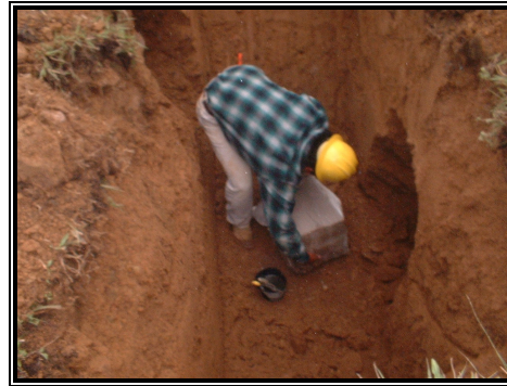
Figura 2.4. Obtención de la segunda muestra inalterada.
