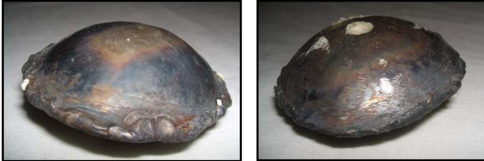
Posteriormente se intentó con una lámina delgada de cobre, tratando de darle una forma cóncava a manera de que pudiera flotar. Por último coloqué espuma y unicel en tubos de cobre, pero no obtuve el resultado deseado. Se está contemplando rebajar el grosor de las paredes del tubo con un torno para aligerar el peso y que el unicel o la espuma los puedan hacer flotar.
