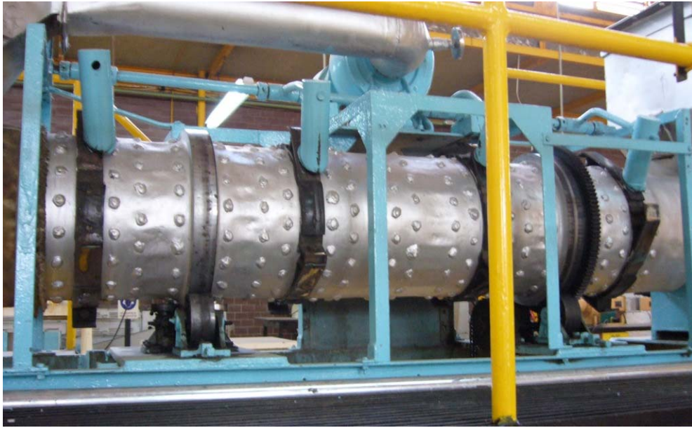
Fig. (27) Imagen del cuerpo del Tambor y sus Martillos.
