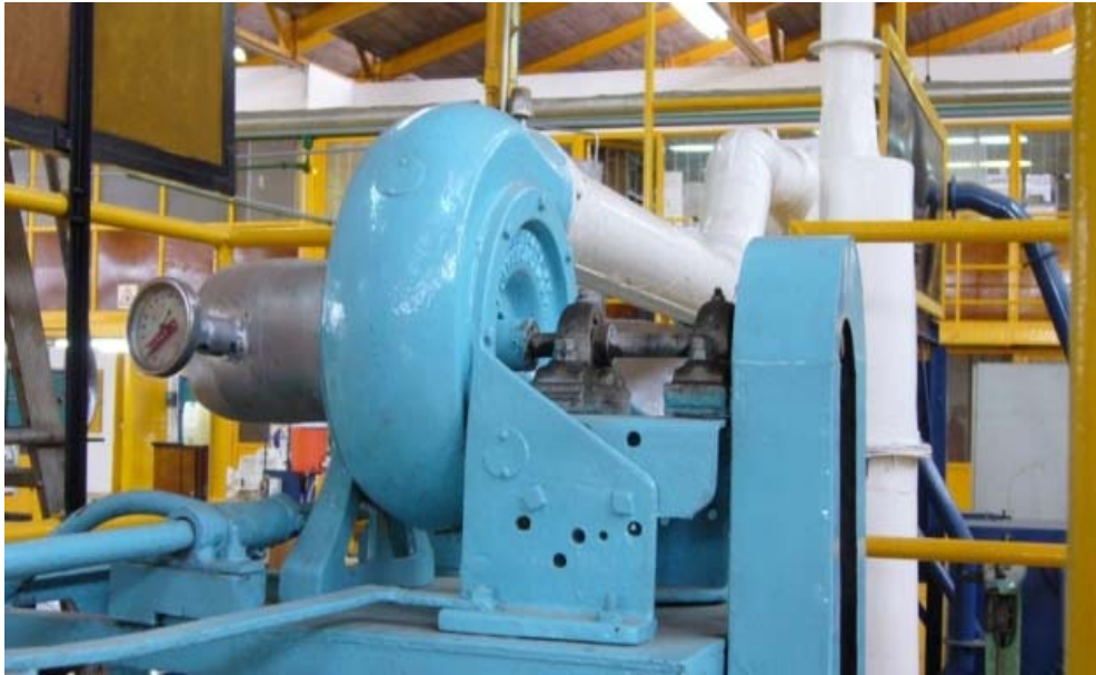
Fig. (20) Imagen con Zoom del Ventilador instalado en el Secador Rotatorio del L.I.Q.
