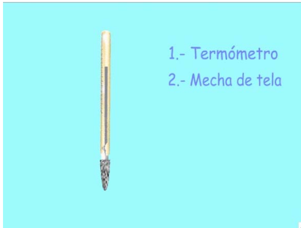
Fig. (12) Termómetro de mercurio con mecha de tela
