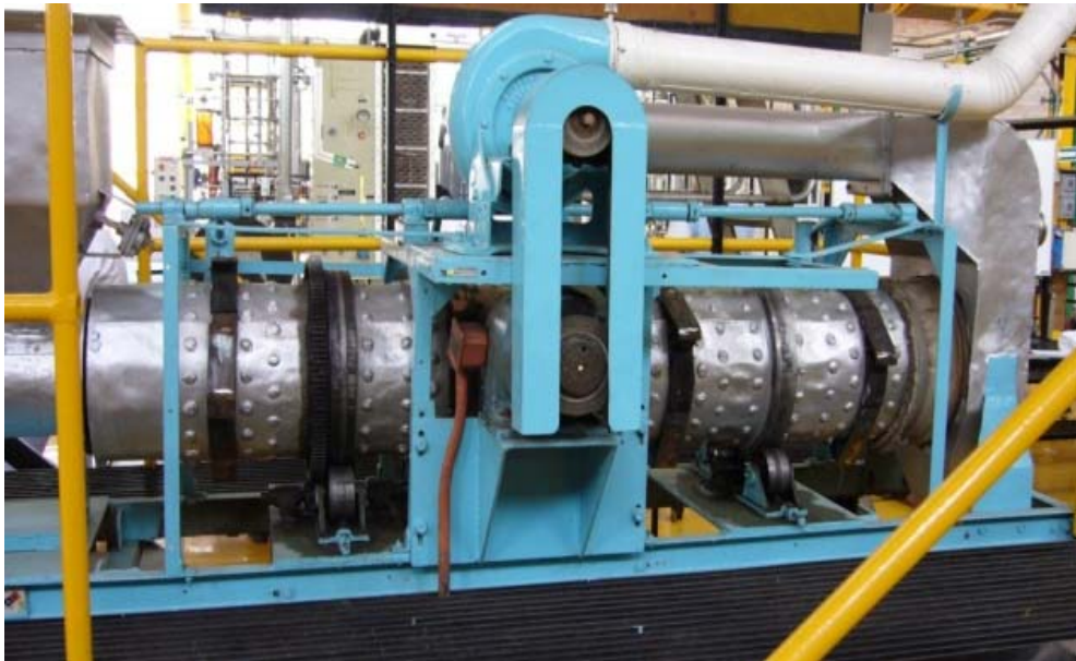
Fig. (21) Imagen del Ventilador instalado en el Secador Rotatorio del L.I.Q.
