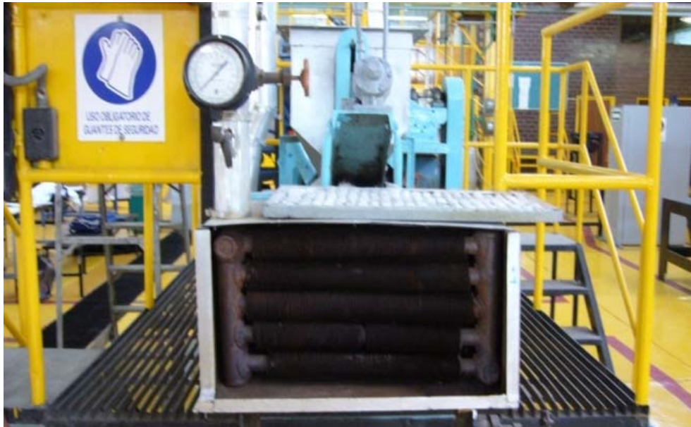
Fig. (19) Imagen del calentador tipo aletado instalado en el Secador Rotatorio del L.I.Q
