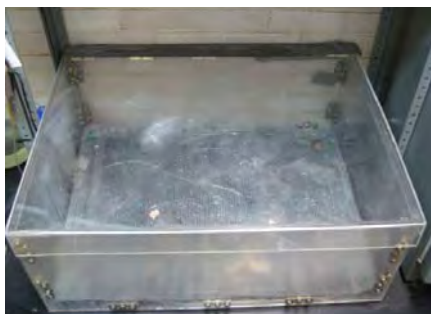
Fig 6. Cámara de curado
