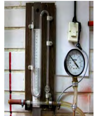
Fig 5. Columna de Mercurio y Manómetro
