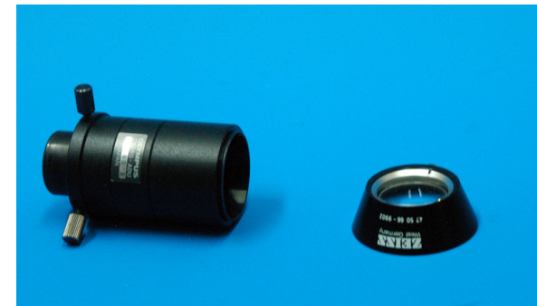
Fig. 24 Accesorios para el microscopio estereoscópico. (Izquierda) Extensión especial para adaptarse al microscopio estereoscópico y (derecha) lupa 2x (de izquierda a derecha) se coloca como lente auxiliar en el estereoscópio.
