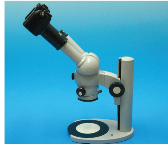
Fig.28 Para realizar la Fotografía estereoscópica es indispensable trabajar con una cámara, que a diferencia de otras tipo reflex, el enfoque se realiza con funciones predefinidas, físicamente es más ligera ya que se adapta al estereoscopio por medio de una extensión que se coloca en el ocular del microscopio.
