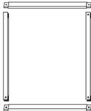
Se utiliza madera de 2" se cortan 4 secciones de 80cm x 80cm con sistema machihembrado (una entra en el interior de la otra) se unen en las esquinas con tornillos de 4"x10cm.
