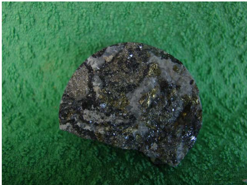
Fotografía 31: DSJ-08 . Pirita, galena, esfalerita, calcopirita alojadas en la veta de cuarzo. Profundidad: 38.59 m.
