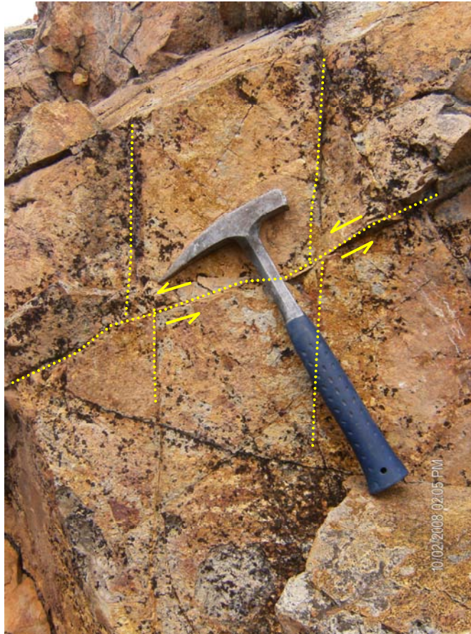
Fotografía 16: Fallas laterales (izquierda) en tobas (unidad Tvi), en la ladera sur del cerro Yabeló. Las líneas punteadas muestran planos de falla y fractura.
