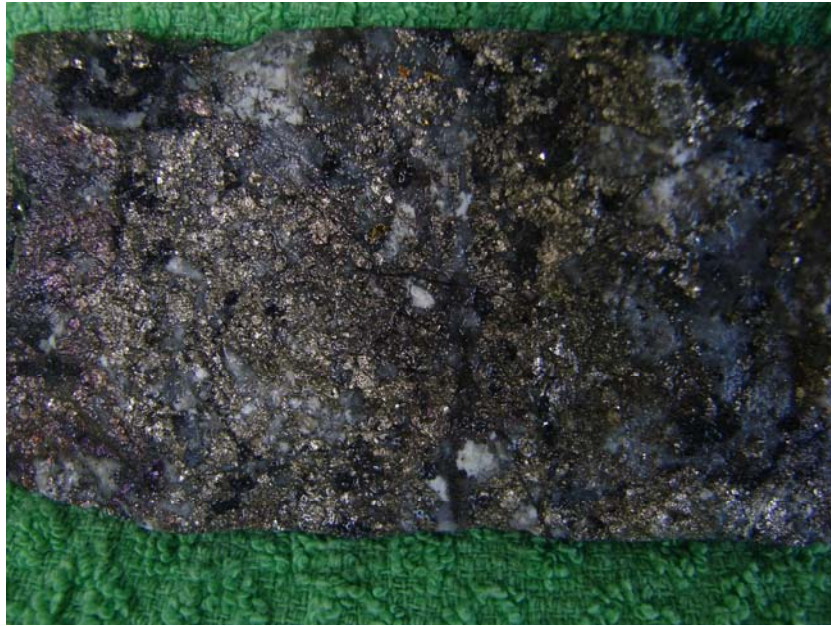
Fotografía 34: DSJ-08 . Pirita, galena, esfalerita, calcopirita y bornita alojadas en la veta de cuarzo. Profundidad: 47.30 m.
