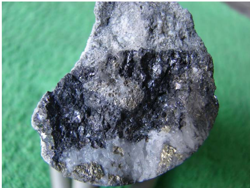
Fotografía 29: DSJ-08 . Banda de galena y esfalerita alojada en la veta de cuarzo pirita diseminada en ambas estructuras. Profundidad: 38.30 m.
