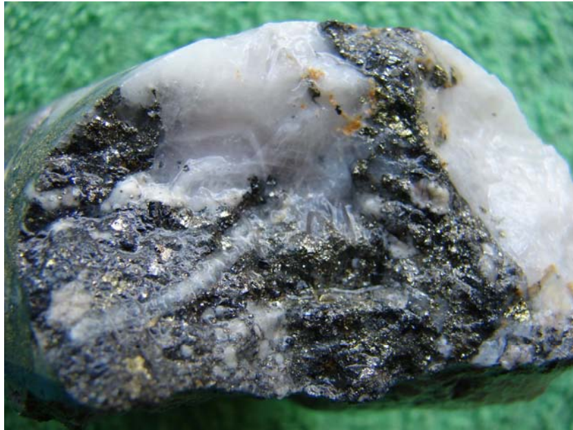
Fotografía 28: DSJ-08 . Veta de cuarzo con pirita y galena, la galena se presenta en bandas y en forma diseminada. Profundidad: 37.60 m.
