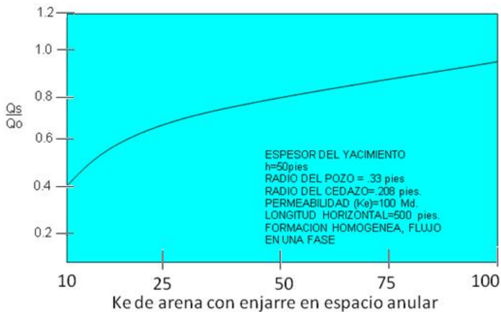
Figura II.17 Efecto del daño a la formación causado por colapso alrededor del cedazo o TR en un pozo horizontal
