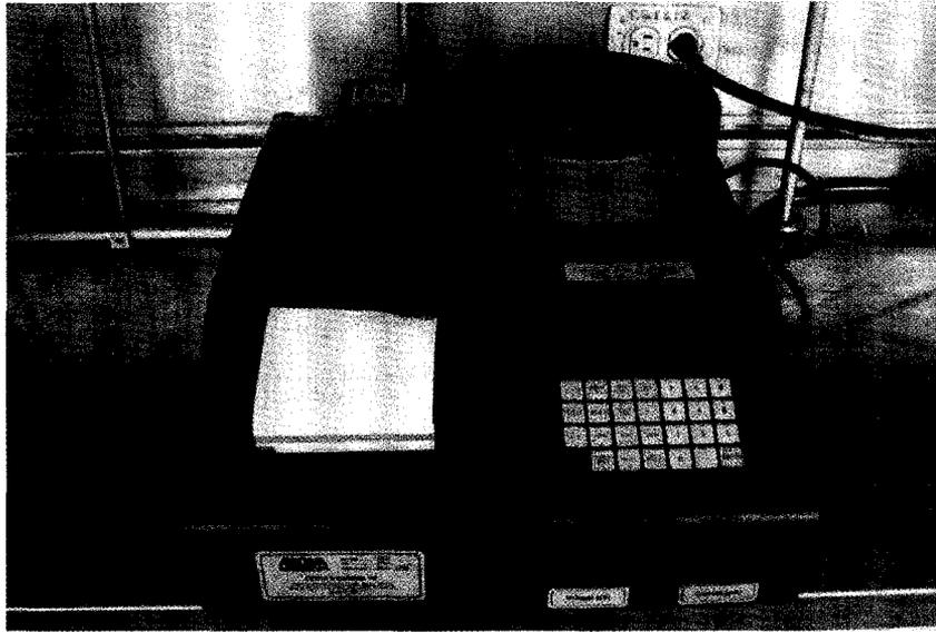
**Fig. 5.2** Equipo de prueba para medir azufre en petróleo y productos del petróleo por dispersión energética de rayos X.
