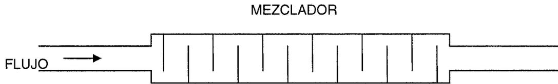
**Fig. 6.7. Diagrama de colocación de un mezclador en línea en una tubería de transporte de hidrocarburos.**
