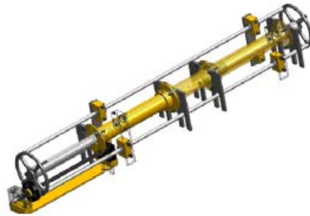
Figura 3. Reómetro con perfil parabólico en 3D
