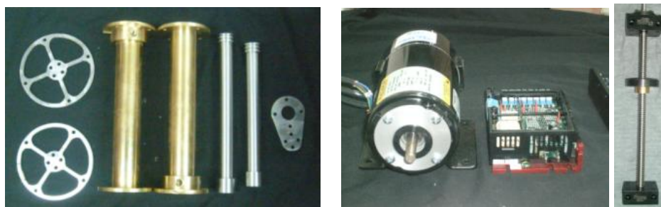
Figura 18. Componentes principales del reómetro de orificio.
