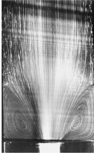
Figura 12. Experimento de visualización de flujo a través de orificio (Zirnsak et al , 1998)
