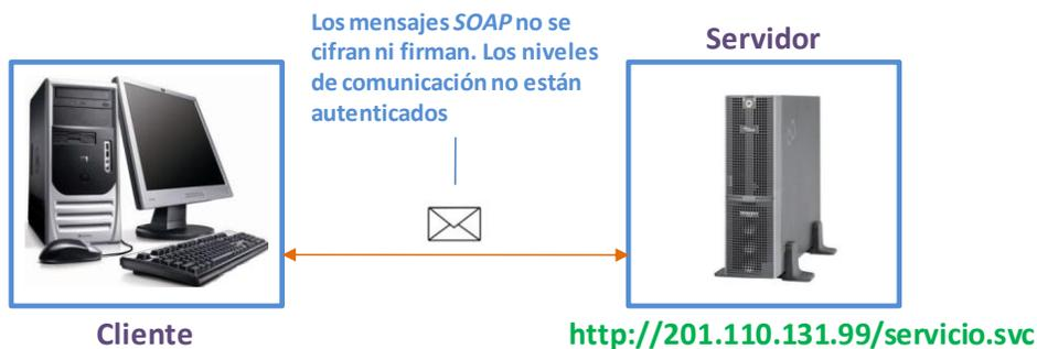
Figura 3.1 Enlace no seguro en Windows Communication Foundation<sup>17</sup>
