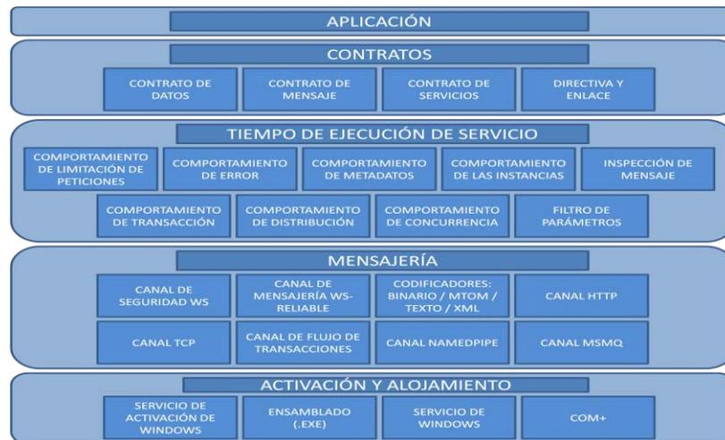
Figura 2.1 Capas de la arquitectura de Windows Communication Foundation<sup>7</sup>
