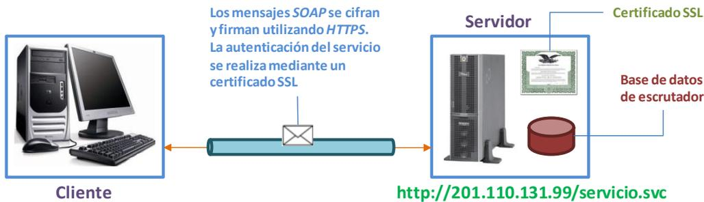
Figura 3.2 Enlace seguro con autenticación básica<sup>18</sup>
