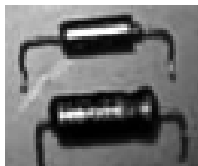
Figura III-16. Capacitores de mica.
