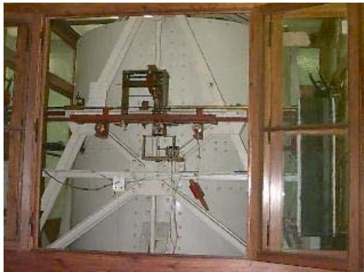
**Fig 2.4 Sismógrafo horizontal Wiechert de 17,000 kilos 1910**
