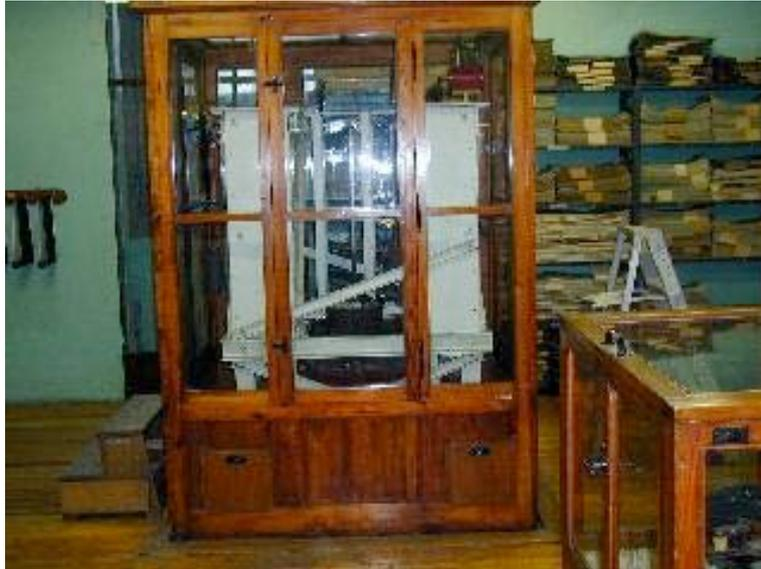
**Fig 2.5 Sismógrafos Verticales Wiechert de 1300 kilos 1910**
