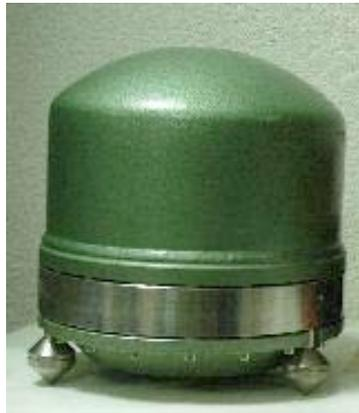
**Fig 2.7 Sismómetro de Banda ancha STS-2**
