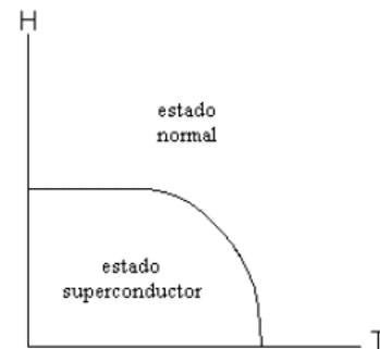
Figura 14: Dependencia del campo con la temperatura para un superconductor tipo I Tomada de Dann, Reactions and Characterization of Solids [5]
