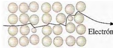
Figura 6: Movimiento de un electrón en un cristal con defectos a nivel atómico. Tomada de Askeland, La ciencia e ingeniería de los materiales [2]
