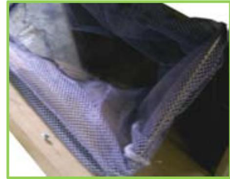
Malla (100% nylon): tejido plano, resistente a la tensión, apariencia agradable, permite la ventilación.
