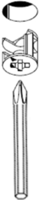
El herraje de unión Minifix, funciona con el principio de bola concéntrica, lo que permite el centrado automático del perno e impide el desplazamiento de los travesaños.
