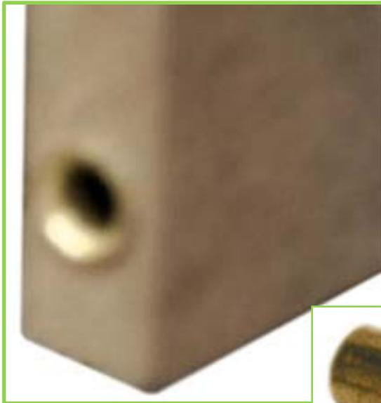
Para solucionar este problema se usó un ojillo de latón dentro del canto de la puerta y una barra de metal como eje de giro, esto eliminó la fricción y permitió que las puertas resistieran el giro.
