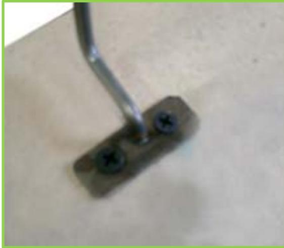
Se soldó una lámina al extremo de la barra la cual tiene dos barrenos para atornillarse a la tabla.
