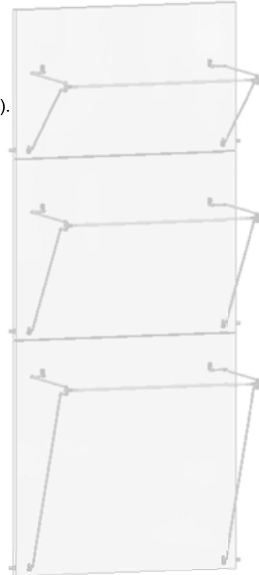
7 Meter los pivotes de las 3 puertas en los barrenos del lateral izquierdo.
