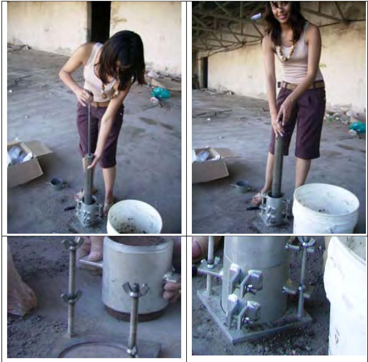
Imágenes: preparación de cilindros para pruebas de compresión
