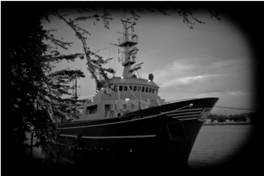
**Figura 9. Buque Oceanográfico *Justo Sierra de la UNAM*. Las dimensiones del buque son 50 m de eslora, 10.3 m de manga y 4.7 m de calado.**
