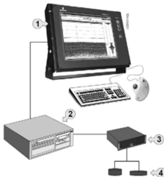
**Figura 11. Esquema de la ecosonda EA400 de Simrad-Kongsberg. (1) Interfaz Gráfica, ( 2) Unidad de procesamiento, (3) Generador y receptor de señal o GPT (General Purpose Transceiver), y (4) Transductores**
