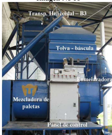
Panel de control, Transportador helicoidal (Bodega 3 – Tolva báscula), Mezcladora horizontal de paletas, Enmelazadora
