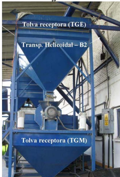
Transportador helicoidal (Bodega 2 – Tolva receptora), Tolva receptora de grano entero (TGE), Tolva receptora de grano molido (TGM)
