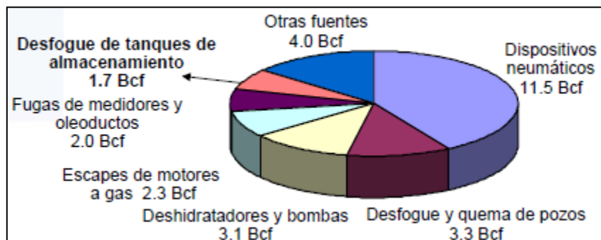
Figura 3.3. Principales fuentes de venteo a la atmósfera. (Taller de Transferencia de Tecnología PEMEX y Agencia de Protección Ambiental, EUA 25 de abril de 2006 Villahermosa, México)
