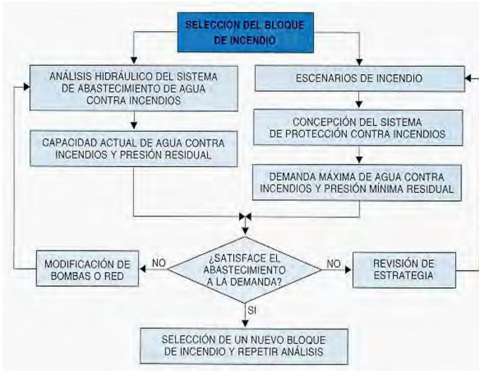
**Fig. 4.2.: Esquema orientativo para evaluación de abastecimiento de agua contra incendios y sistema de distribución basado en el análisis del riesgo de incendio.**
