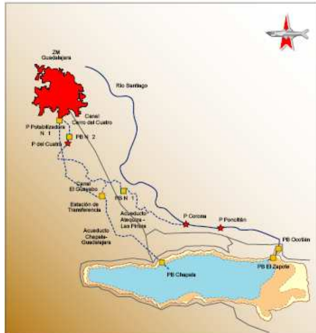
Figura 2.22 Conducción y bombeo del acueducto Chapala-Guadalajara
