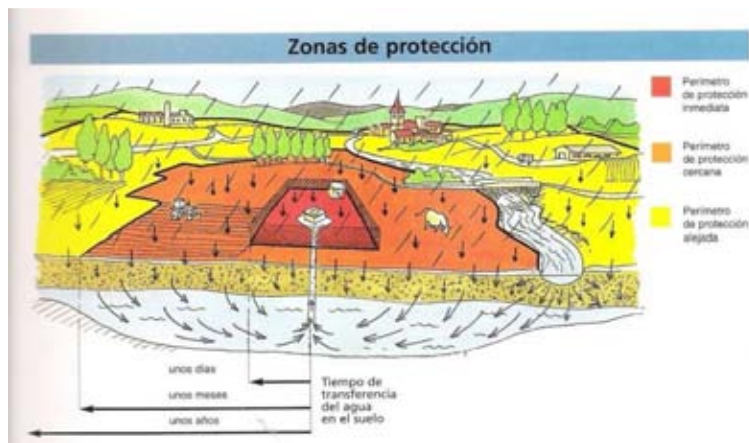
Figura 4.5 Zonas de protección de un manantial
