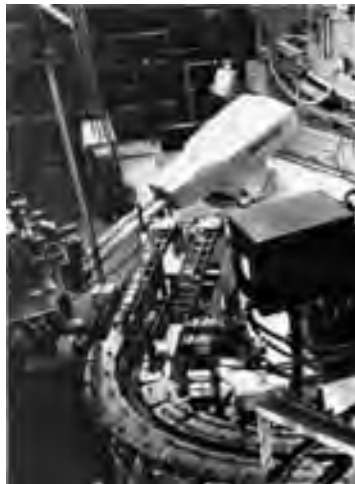
Figura 5. UNIMATE. Primer robot industrial que comienza a trabajar en la planta de General Motors, Co. en 1962. Fotografía tomada de la página Practical Robots Service. En: http://www.prsrobots.com/1961.html
