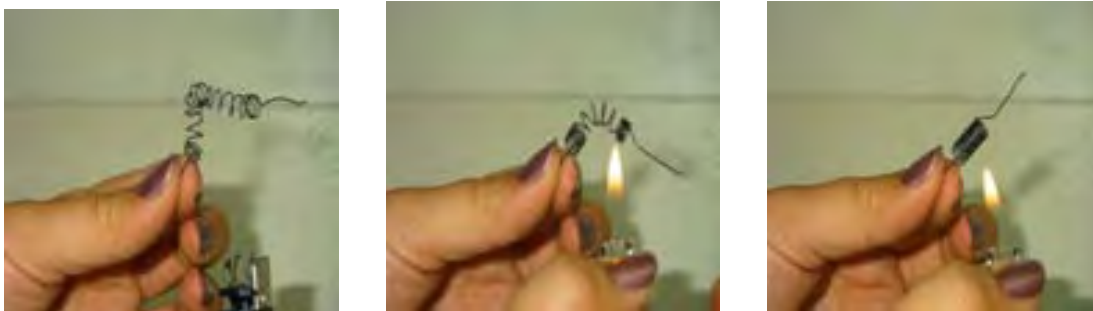
Figura 13. Comportamiento de un material con memoria de forma al aplicar un incremento de temperatura. Fotografías tomadas de la página del Departamento de Física de Materiales de la Universidad Complutense de Madrid. En: http://material.fis.ucm.es/paloma/congreso08/ficheros_trabajos/8/presentacion8.pdf Consultada: 27/02/2009.
