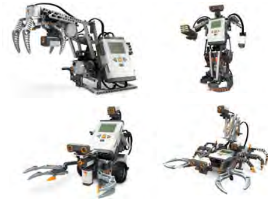
Figura 42. Juguete Lego Mindstorms NXT®, incluye cuatros sensores y tres servomotores para la interactividad y el desplazamiento. Imagen tomada de la página electrónica del fabricante. En: http://mindstorms.lego.com/eng/Cpoenhagen_Dest/Default.aspx . Consultada: 08/04/2009.
