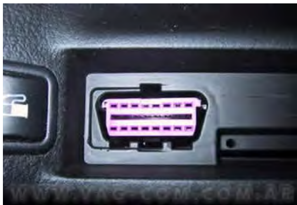
Figura 14. Conector de diagnóstico del automóvil para introducir la interfase inteligente. Fotografía tomada de la página electrónica de la empresa VAG-COM. En: http://www.vag-com.com.ar/ . Consultada: 04/03/2009.
