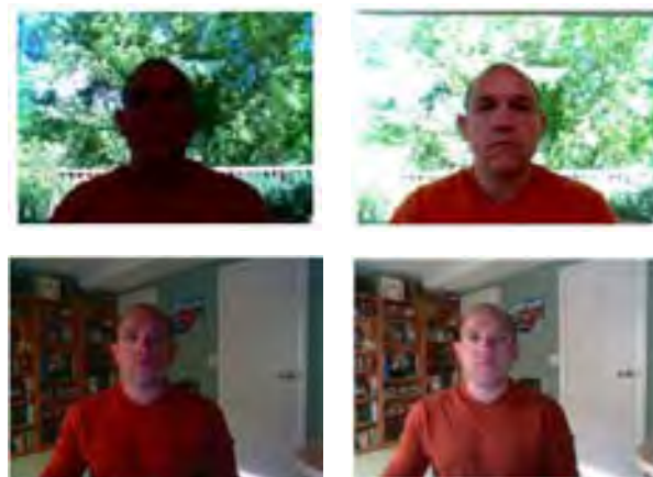
Figura 18. La cámara QuickCam® Sphere AF viene integrada con la tecnología RightLight 2, que permite un ajuste automático de la imagen, controlando, el color de saturación, brillo y contraste, de manera automática. Fotografía tomada de Logitech Innovation Brief. En: http://logitech-louk.navisite.net/web/ftp/pub/pdf/cameras/rightLight2_innovation_brief_enu.pdf . Consultada: 05/03/2009.
