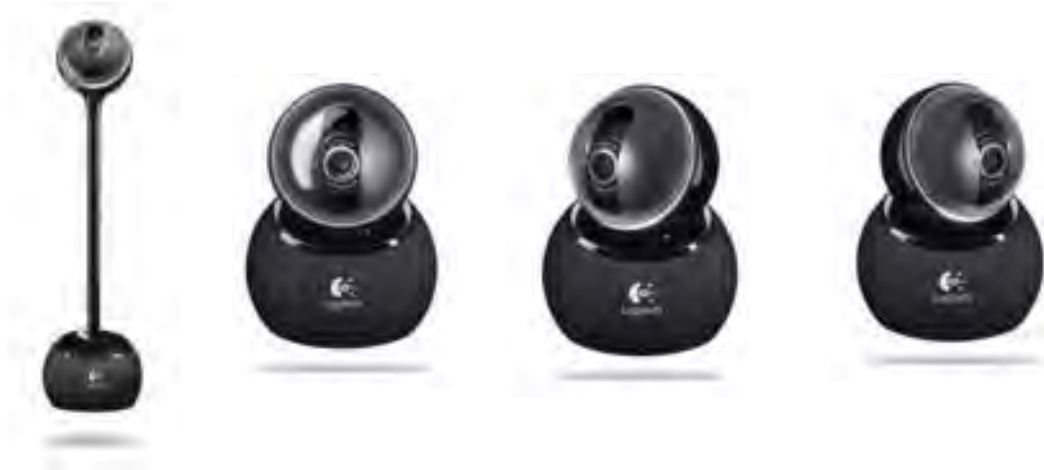
Figura 17. Cámara Web de Logitech modelo QuickCam® Sphere AF. Su mecanismo automático permite seguir a la persona y autoenfocarla cuando esta se mueve. Fotografía tomada de la empresa Logitech. En: http://www.logitech.com/index.cfm/webcam_communications/webcams/devices/3480&cl=es,es
