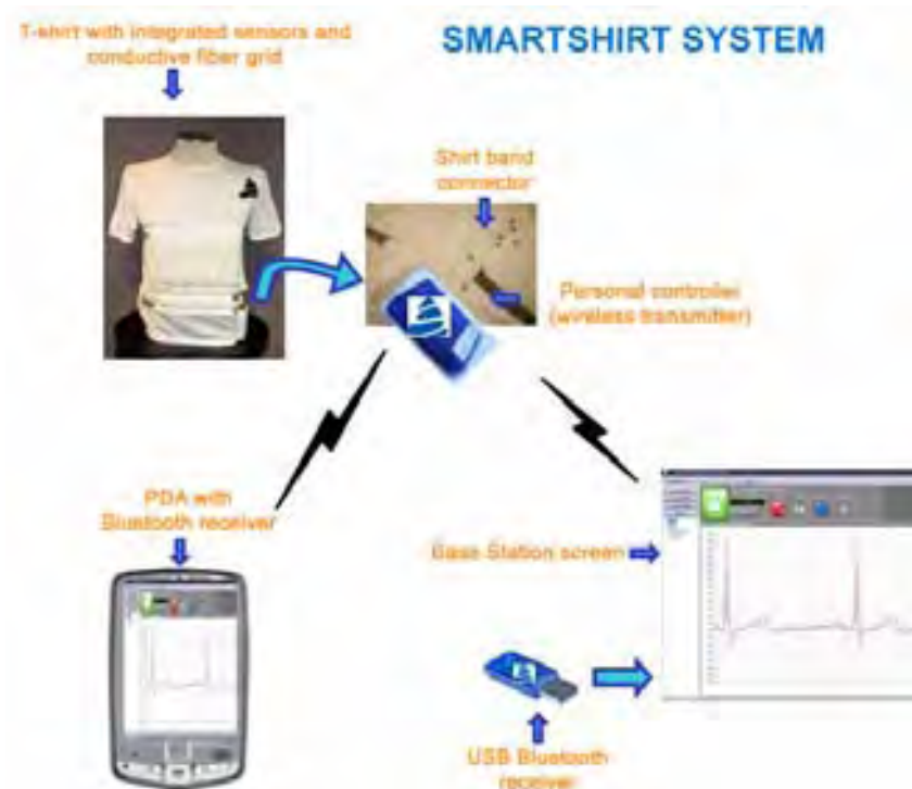
Figura 29. Esquema de funcionamiento de la SMARTSHIRT producida por la empresa Sensatex®. Imagen tomada de la página electrónica del fabricante. En: http://www.sensatex.com/smartshirt.html . Consultada: 24/03/2009.
