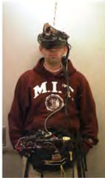
Figura 26. Computadora integrada en la ropa, con dispositivos de Internet, micrófono, sensores de audio y video. Fotografía tomada del artículo Smart Clothing: The shift to wearable computing. En: http://www.eyetap.org/papers/docs/acm_comm96.pdf . Consultada: 13/03/2009.
