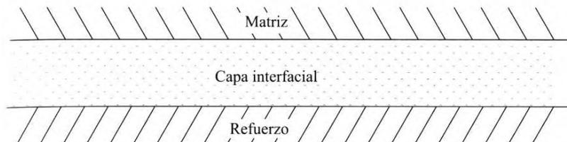
**Figura 2.7** Unión mediante interdifusión en metales y cerámicas.
