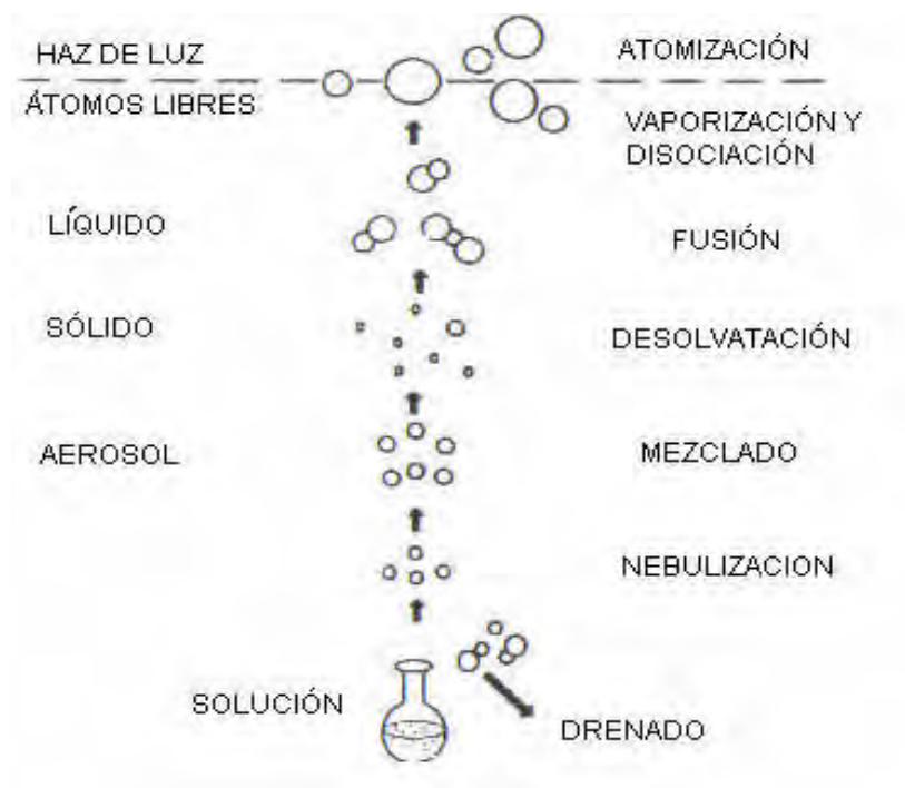
Figura 1.8. Proceso de atomización en flama.
