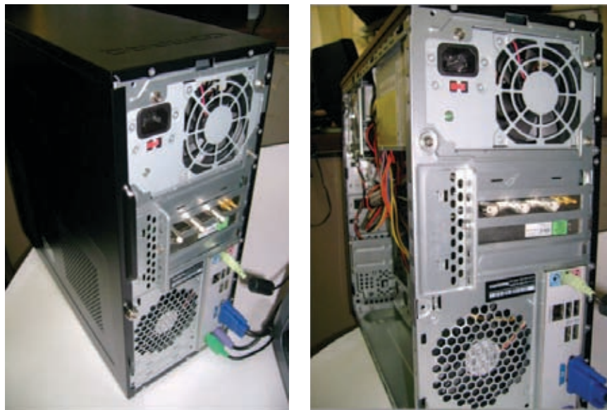
Figura A8. Localización de los conectores de la tarjeta NI PCI-5152 en la PC.
