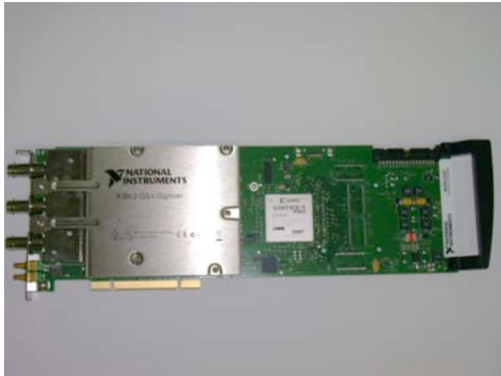
Figura A5. Tarjeta NI PCI-5152 que en cuto extremo (a la derecha) tiene un sostén metálico a través del cual se debe manipular.
