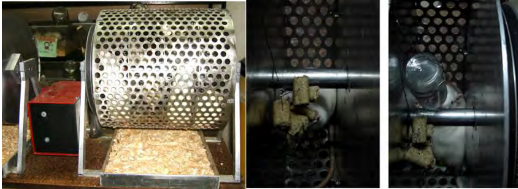
Figura 3. Rueda de actividad forzada para modelar condiciones del trabajador nocturno. Rueda que consta de cuatro divisiones con una rata en cada una, con rotaciones lentas que mantienen despiertos a los animales durante las 8 horas (lunes a viernes), con acceso libre al alimento y agua.
