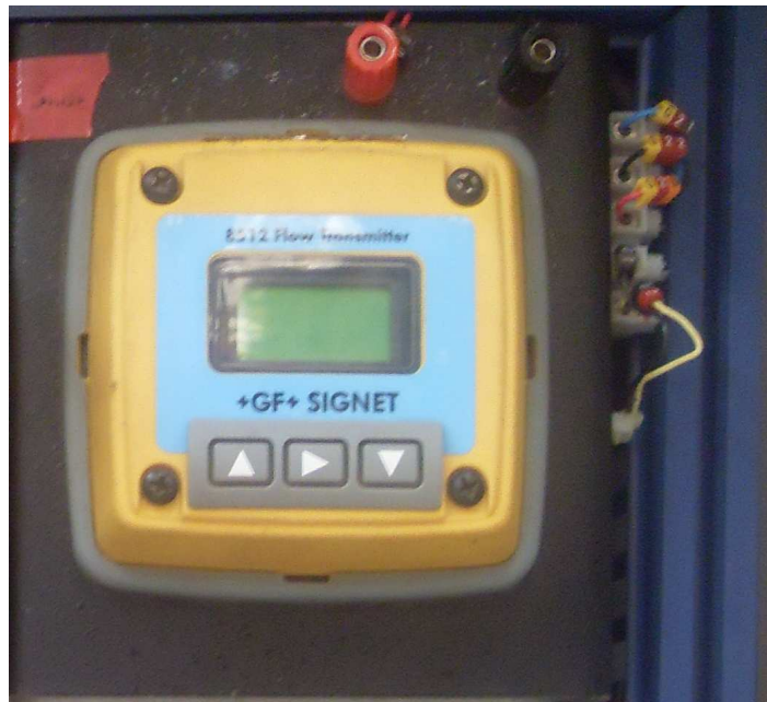
Figura 2.8: Transductor para el sensor de flujo
