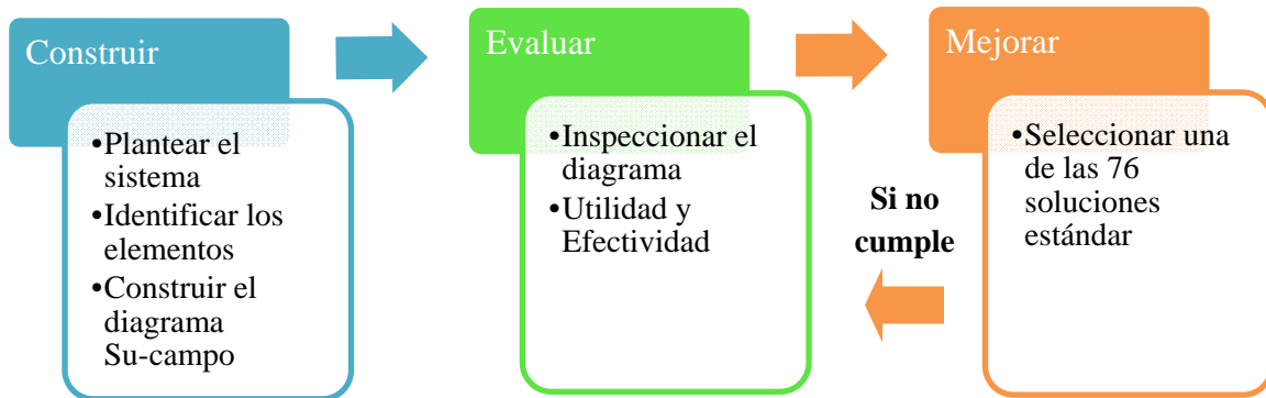
Figura 1.6. Esquema del proceso de aplicación del análisis sustancia-campo.
