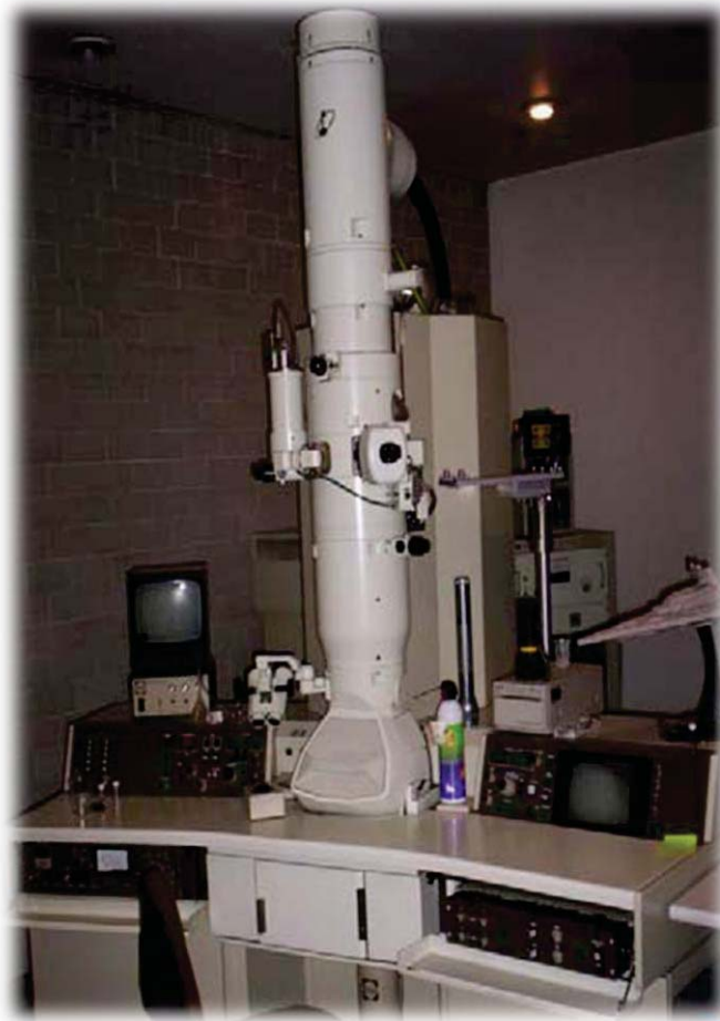
Figura 4.13 Arriba, microscopio electrónico de transmisión (TEM); abajo, microscopio electrónico de barrido (SEM).
