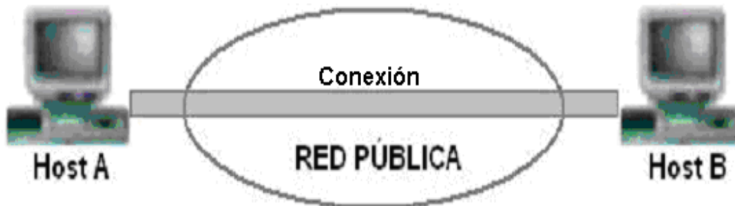
Figura 5.32 IPsec en modo transporte
