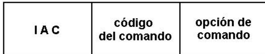
Figura 6.23 Formato de comandos en TELNET
