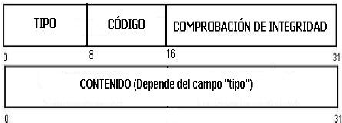
Figura 3.7 Formato de los paquetes ICMP
