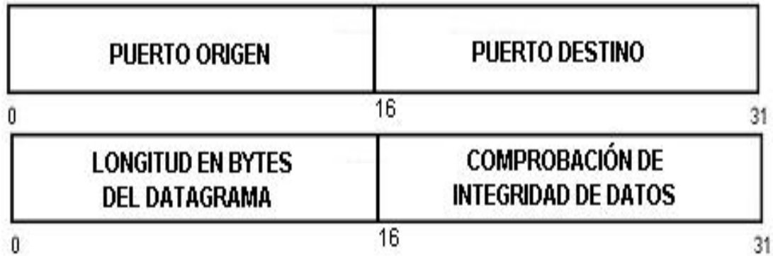
Figura 3.8 Formato de los paquetes UDP
