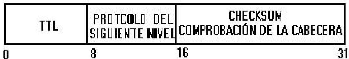
Figura 3.6 Formato de los paquetes IP para TTL
