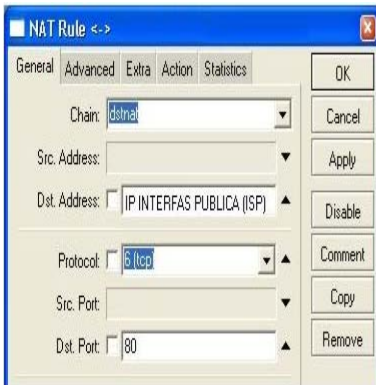
Figura 5.24 Regla NAT para redireccionar el proxy al servidor web
