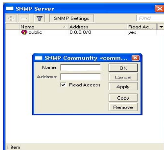
Figura 6.10 Habilitación del servidor SNMP de Mikrotik
