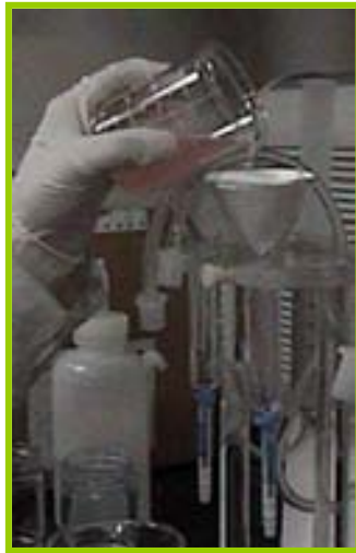
Figura 57. Filtración en columnas
