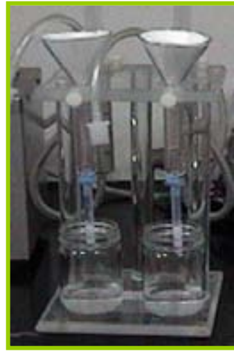
Figura 58. Filtración en columnas (2)
