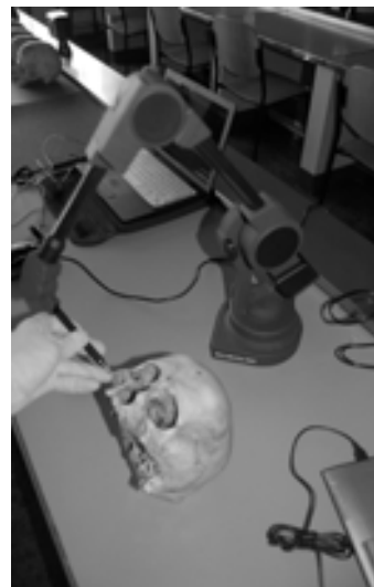
Figura 3.8. Aspecto del área de trabajo del aparato y de los elementos necesarios (pc, brazo y observador) para la digitalización de un cráneo.
