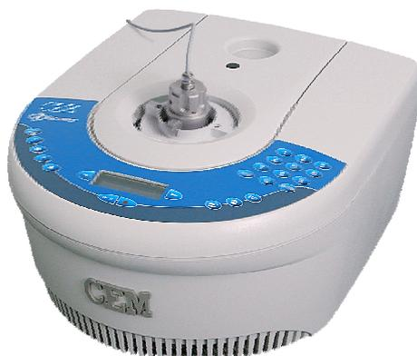
**Figura 9.** Horno monomodal "Discover™" con sistema BenchMate.
