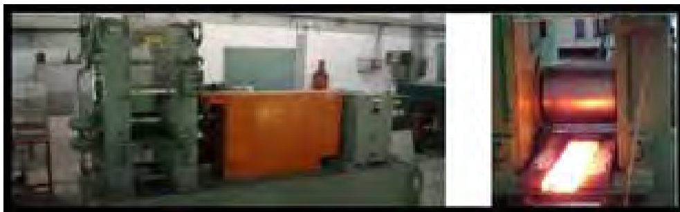
Figura 3.1: Izquierda, Laminadora Fenn reversible. Derecha, Fotografía de una pieza deformada en caliente a la salida del tren de laminación.
