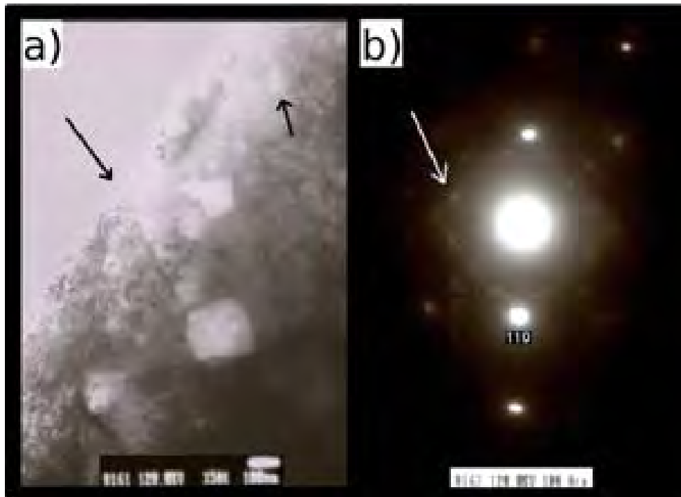
Figura 4.25: Fotografías en microscopio electrónico de transmisión en campo claro (a) donde se observan precipitados de Niobio desde 20 hasta 100 nm en forma de cubo en límite de grano señalado en la figura, y patrón de difracción (b) del área seleccionada en la fotografía anterior donde se indexan planos (110) de la ferrita y precipitados de NbC.
