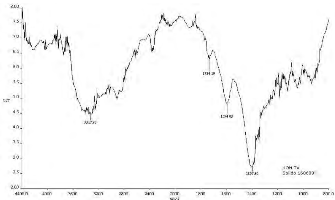
Figura 38. Espectro de FT-IR del material cuticular residual de la hidrólisis con KOH.
