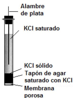
Figura II.6 Esquema del electrodo de referencia de plata /cloruro de plata, Ag/AgCl.
