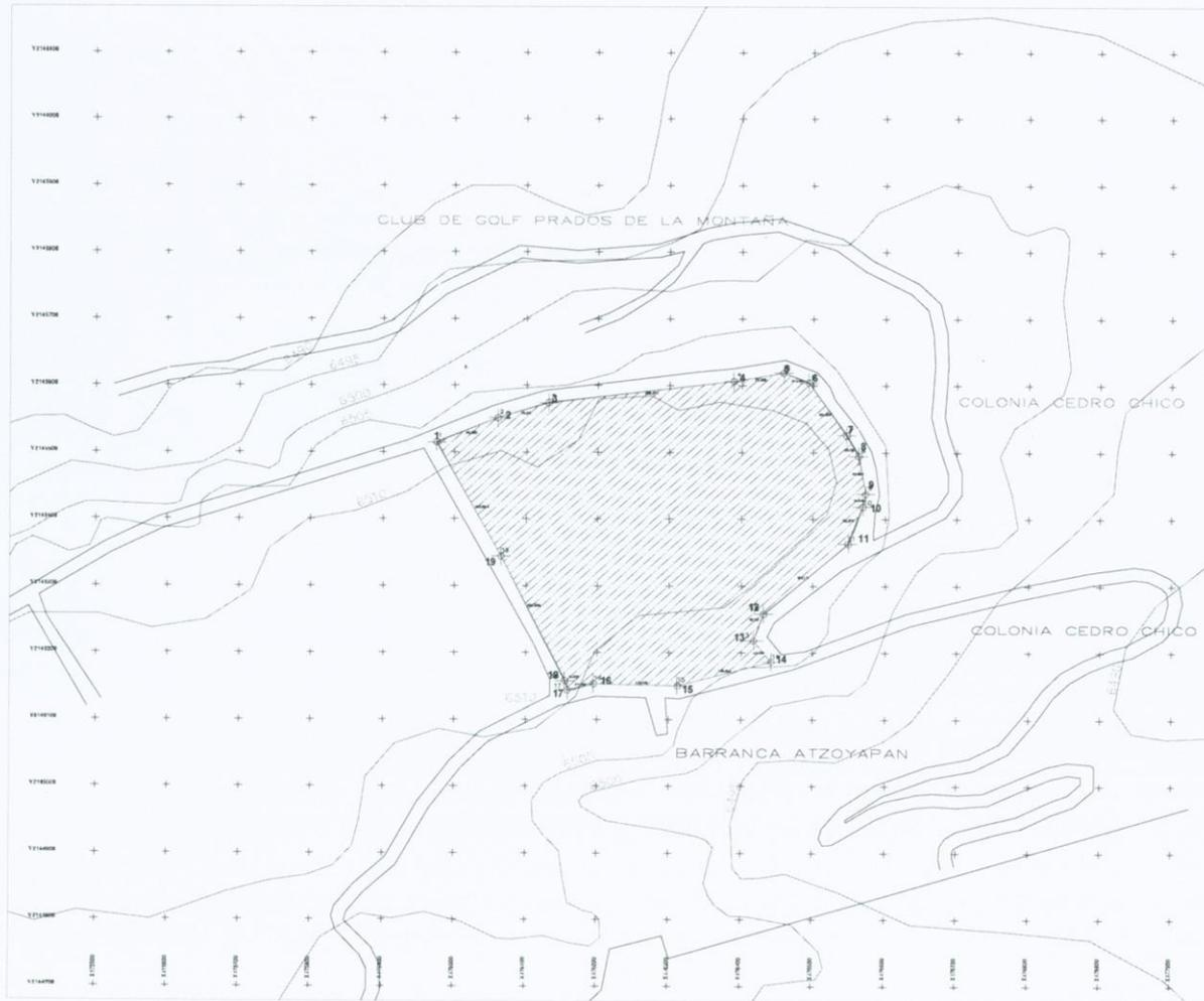
Fig. 5 Plano topográfico del terreno propuesto, en donde se aprecian las curvas de nivel y la poligonal del mismo.
