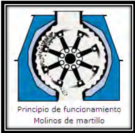
FIGURA 3-9. TRITURADORA DE MARTILLO, a) Funcionamiento, b) trituradora de martillo.
