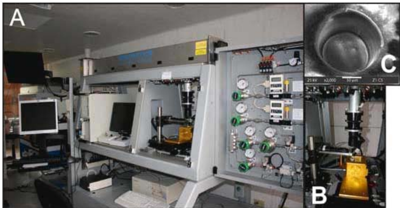
Fig.3.1. Equipo de LA-ICP-MS del Centro de Geociencias (CGEO-UNAM). A) Apariencia general del equipo. B) Detalle de celda de ablación y su cono interno de ablación. C) Cráter de ablación en círculo obtenido con los parámetros de operación descritos. Modificado de Solari et al. (2009).
