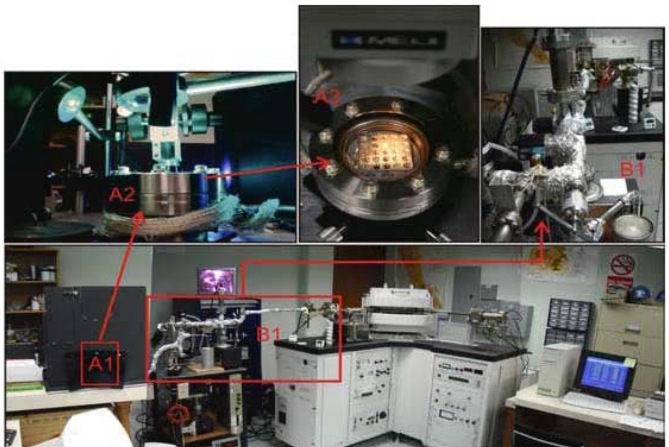
Fig. 3.2. Espectrómetro de masas VG5400 del laboratorio de geocronología del CICESE. A1) Zona de manipulación del portamuestras, A2) Laser incidiendo sobre el portamuestras, A3) Charola con 25 muestras dentro del portamuestras. B1) Línea de extracción y conducción de Ar desde la muestra al espectrómetro de masas.
