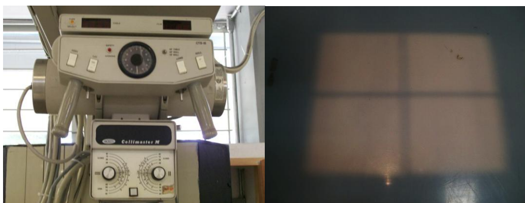
Figura 11: Ejemplo de un colimador y la luz que proyecta en la mesa de rayos x. Cortesía del Hospital de Especialidades Veterinarias FMVZ.
