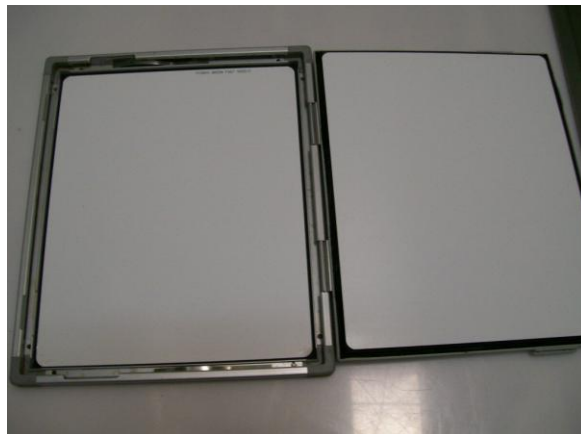
Figura 17: Pantallas intensificadoras dentro del chasis. Cortesía Anatomía Topográfica FES Cuautitlán 2008.
