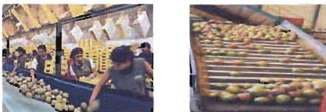
Fig. 24 Selección manual (A) y Selección mecánica de mango (B) Fuente: Valeriani (2003); PROSERCO Campeche (2004)
