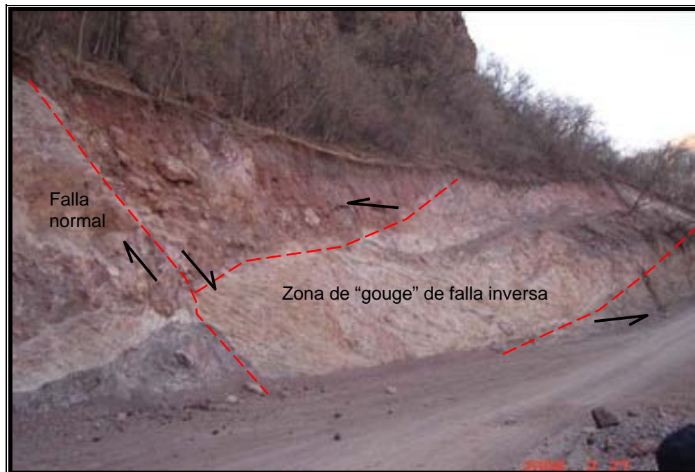
Figura 73.- La litología de color claro corresponde al "gouge" de falla, a la izquierda una falla normal desplaza a la falla inversa. De manera similar a la estación anterior, pero con una inclinación mayor, la ondulación de la estructura da lugar a la apariencia de falla normal.
