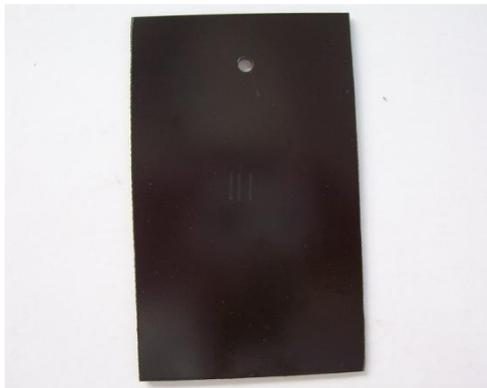
**Figura 16. Marca dejada por el lápiz en la prueba de dureza realizada a las placas de acero grandes pintadas a nivel industrial.**
