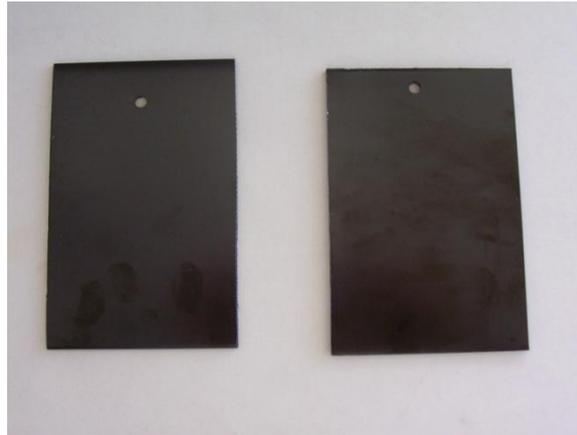
**Figura 15. Placas de acero grandes pintadas a nivel industrial por electrodeposición de pintura catiónica obteniendo un espesor de pintura de 20 micras.**
