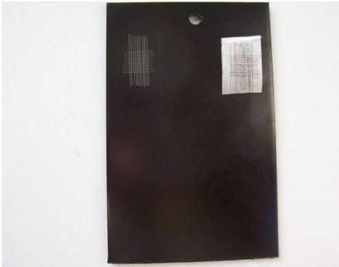
**Figura 17. Prueba de adherencia rayado y desprendimiento de la cinta adhesiva sin ningún cuadrado de pintura realizada a las placas de acero grandes pintadas a nivel industrial.**
