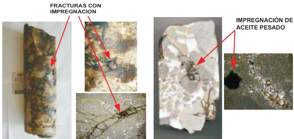
Fig. 4.2 Impregnación de hidrocarburos
