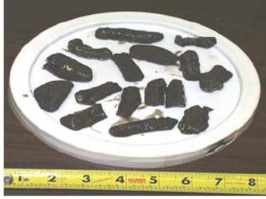
Fig. 4.8 Los derrumbes son diferentes que los cortes normales de la barrena por ser más grandes y más ovalados.
