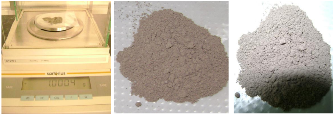
Fig. 5.9 a) Se pesa exactamente un gramo de la muestra molida en la balanza analítica; b) Gramo de caliza; c) Gramo de otra muestra
