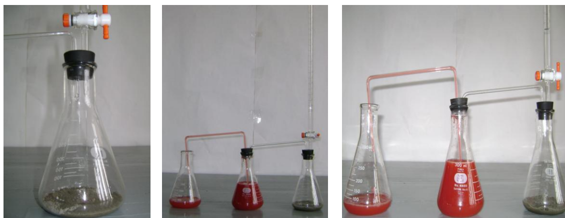
Fig. 5.12 a) Reacción de ácido clorhídrico, b) Liberación del \text{CO}_2 , c) Desplazamiento de líquido
