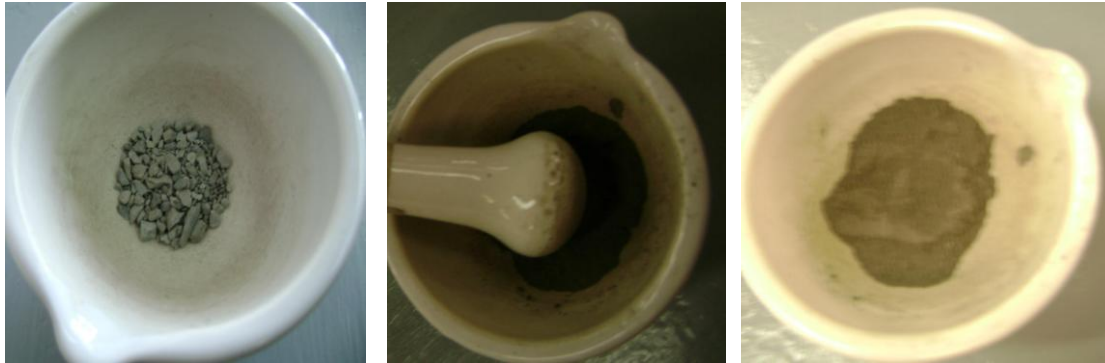
Fig. 5.7 a) Se coloca la muestra en el mortero, b) Se empieza la molienda de la muestra, c) La muestra finamente molida.
