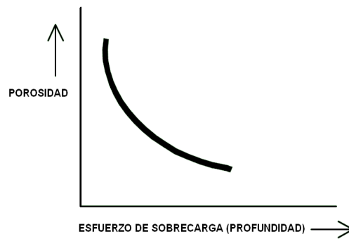
Fig. 1.3 Efecto del esfuerzo la sobrecarga sobre la porosidad de formación durante la compactación normal.
