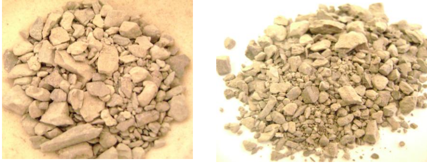
Fig. 5.8 Recortes de las cribas vibratoras tamizadas y lavados
