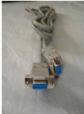
Cable RS-232, Interfaz entre consola y pc
